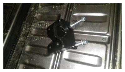
4.5 Выставляем кунг симметрично, относительно кузова. Прикладываем струбцины, и наживляем их на 4 болта 8х25, предварительно установив шайбу и гровер м8.
